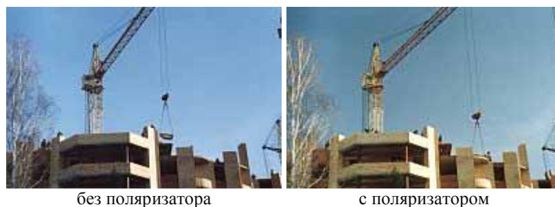
Рис. 11. С помощью поляризатора можно затемнить яркий свет неба по сравнению с другими объектами съемки. При этом появляются красноватые оттенки
